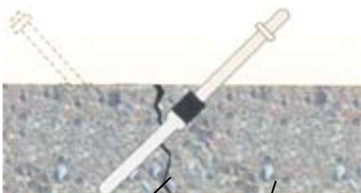
Пробуриваются наклонные отверстия (шпуры) в шахматном порядке, устанавливаются пакеры и закачивается под давлением инъекционный материал.
